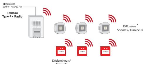
\* La somme des périphériques (déclencheurs manuels + diffuseurs sonores + diffuseurs lumineux) ne doit pas dépasser 20
